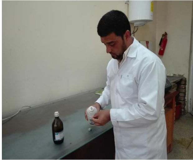
شکل (۶ - a) - جریان چسپ نمودن نمونه درشیشه سلاید درریاست سروی جیولوجی افغانستان
