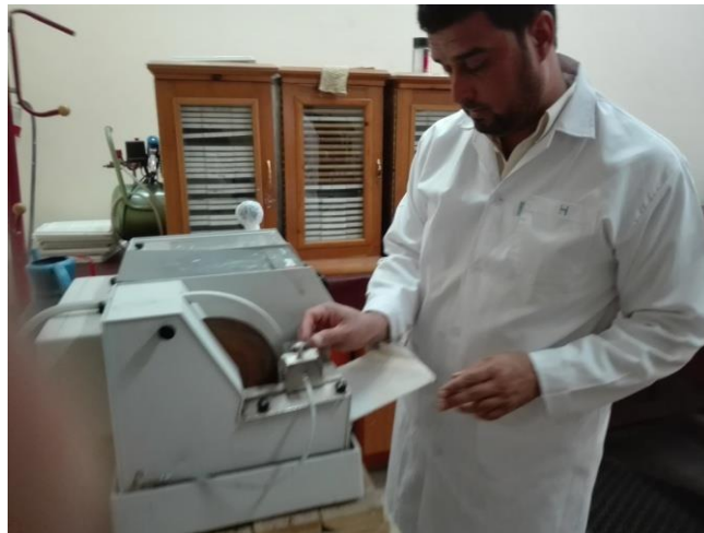
شکل (۷ - a) - جریان پالش کاری ونازک سازی درریاست سروی جیولوجی افغانستان
